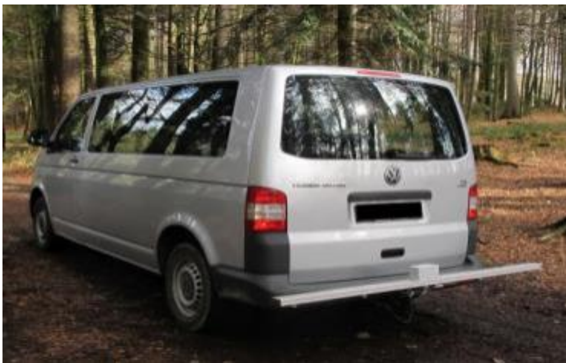
Рисунок 1 - Ультразвуковий сенсорний пристрій для діагностування якості лісових доріг
